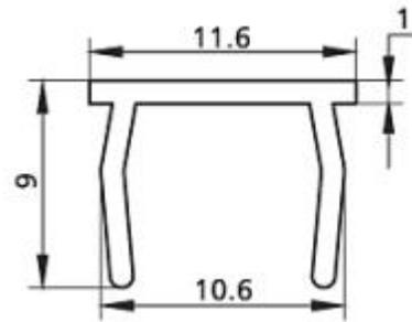
Ajusta en la ranura de 10 mm del perfil de 45x45 mm mod. 14-040
