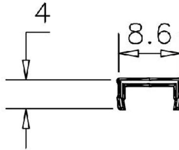
Ajusta en la ranura de 8 mm tanto del perfil 30x30 mod. 12-030 como del perfil 40x40 mm mod. 10-040
