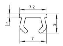
Ajusta en la ranura de 6 mm del perfil de 20x20 mod. 12-020 y de 25x25 mm 12-1010
